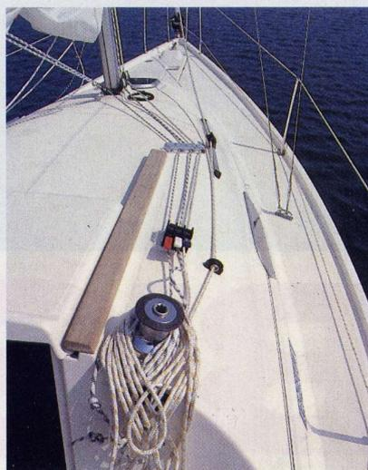
*Tutte le manovre dell'albero sono rinviate in pozzetto e servite dalla batteria di stopper. Sempre sulla tuga anche le rotaie del fiocco.*
