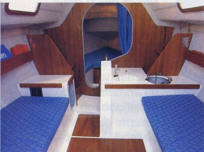
*In primo piano le due cuccette a centro barca e la zona cucina che oltre all'alloggio cardanico per il fornello camping gaz e il lavello ospita il blocco con la maniglia per la regolazione della deriva mobile.*
