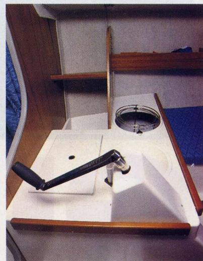
*La maniglia del sistema di azionamento della deriva mobile. Per abbassarla completamente occorrono 100 giri.*
